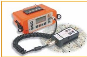
Elcometer 331<sup>2</sup> B Covermeter
